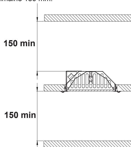
Obr. 3 - Montážní vzdálenosti při montáži na strop
