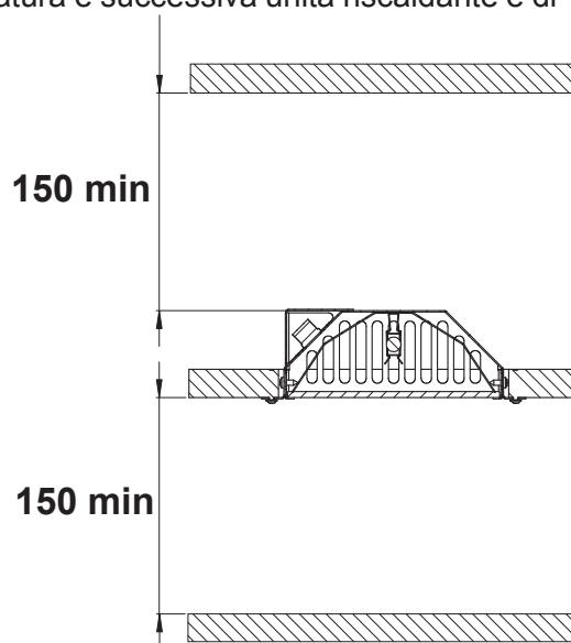
Fig. 3 – Distanze minime per montaggio a soffitto
