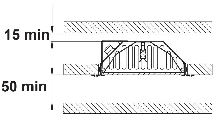
Obr. 2 – Montážní vzdálenosti při montáži na stěnu
