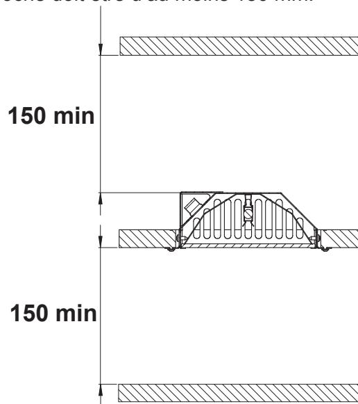
Fig. 3 - Intervalles minimums pour le montage au plafond
