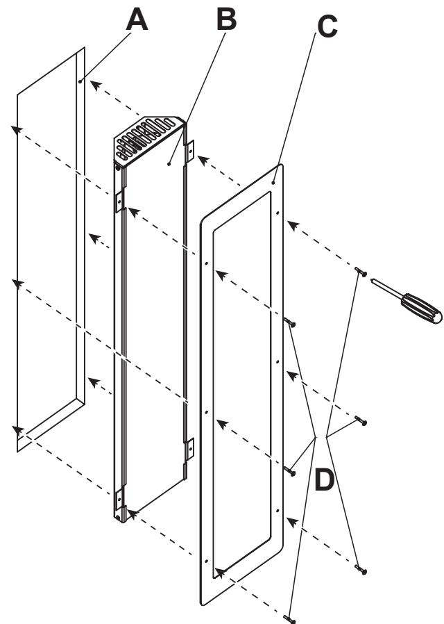
Abb. 5 - Einbau mit Blende
