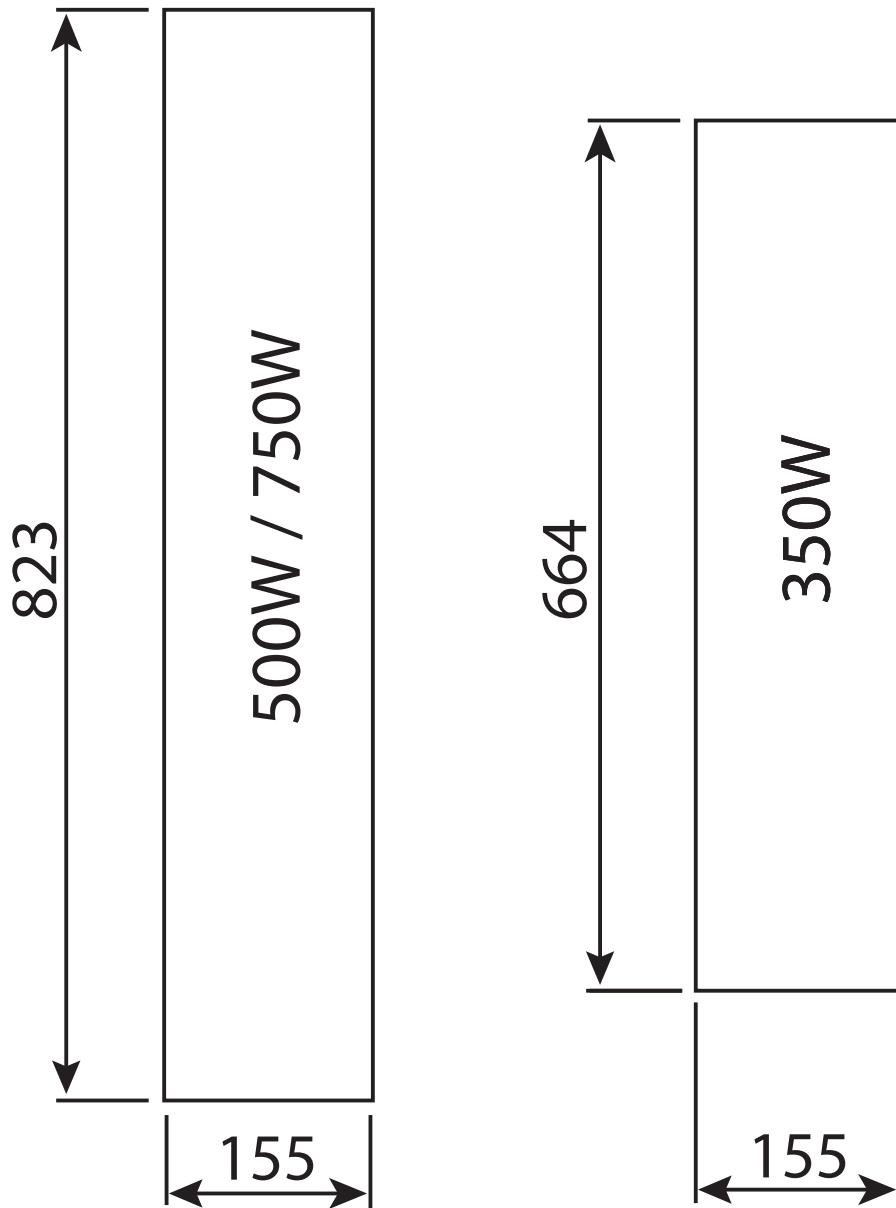
Fig. 1 – Apertura di montaggio
