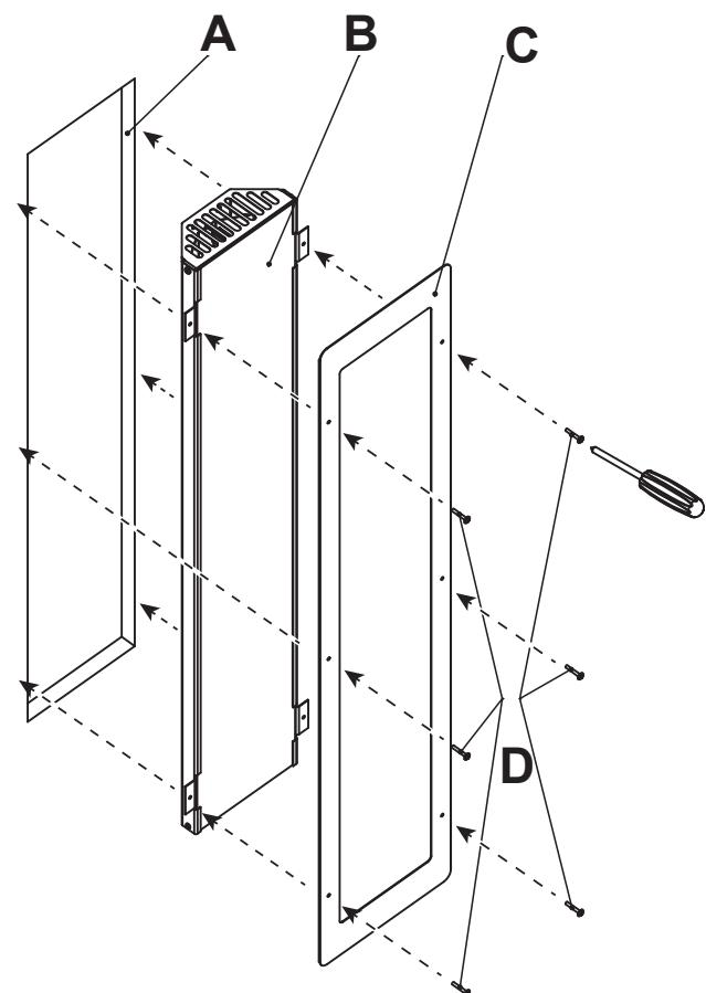
Bild 5 - Installation med panel
